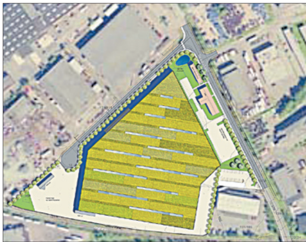
For å bringe mest mulig dagslys inn i gjenvinningsanlegget er det installert store, sammenhengende overlyskonstruksjoner i taket. Det er i alt 14 slike konstruksjoner med bredde 2600 mm og i varierende lengder.
